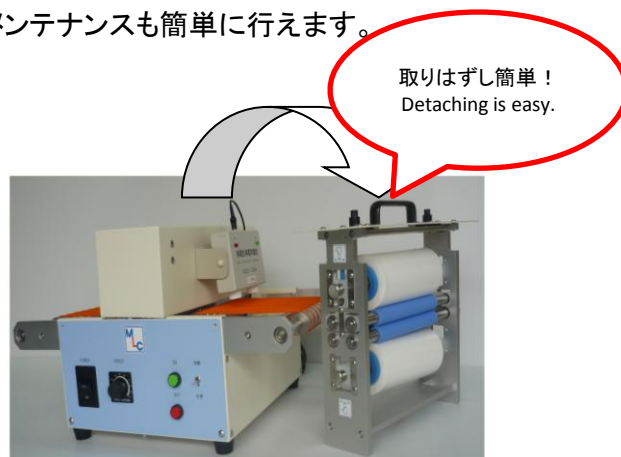
ロール・テープユニット取出し時 Roller and tape roller unit take out.
